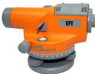
Рисунок 1 – Оптический нивелир EFT AL-32
