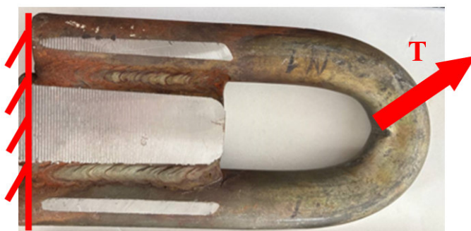
Рисунок 1 – Расчетная схема элемента талрепа
