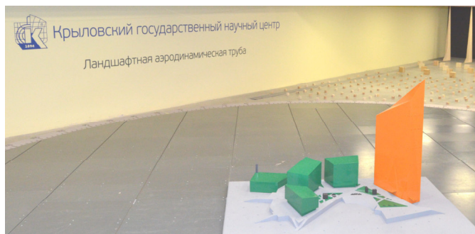
Рисунок 1 – Фотография модели объекта в рабочей части Ландшафтной аэродинамической трубы
