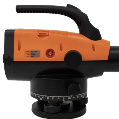
Рисунок 1 – Цифровой нивелир EFT L-0.7
